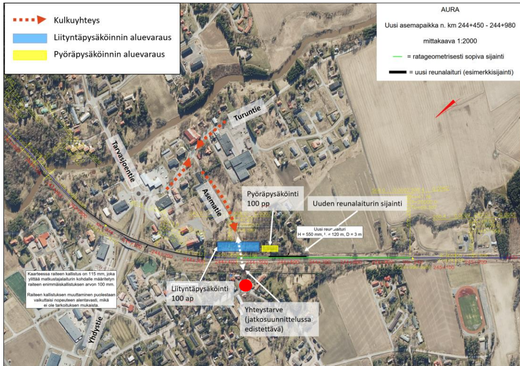
Kuva 28. Kulkuyhteydet Auran asemalle ja aseman liityntäpysäköinti. Uusi ali- tai ylikulku voisi olla tarpeellinen, sillä aseman molemmin puolin on runsaasti asutusta ja Yhdystien alikulun kautta matka asemalta radan toiselle puolelle (punainen piste) olisi noin 1 km.
