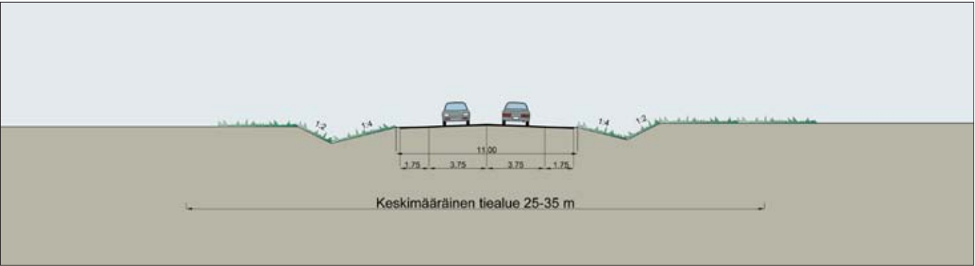
Kuva 31. Valtatiehen 10 poikkileikkaus vaihtoehdoissa 2.
