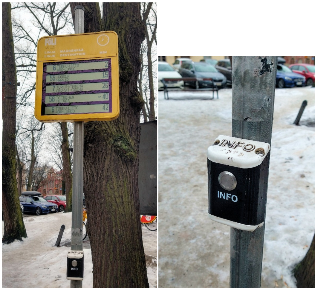
Kuva 6. Bussiliikenteen reaaliaikainen 5-rivinen aikataulunäyttö sekä näyttölaitteeseen kytketty kuulutuslaite. Näyttölaitteita saa erilaisina versioina, kuvan laitteessa on viisi eri riviä, joka mahdollistavat yhtäaikaisesti viiden seuraavan lähdön näyttämisen. Näyttölaitteen ohjelmoinnilla on mahdollista esittää esimerkiksi alimmalla rivillä vaihtuvia tiedotteita tai vielä myöhempien lähtöjen tietoja. Turku, Aurakatu, 21.2.2021. Kuvat: Aarne Alameri.
