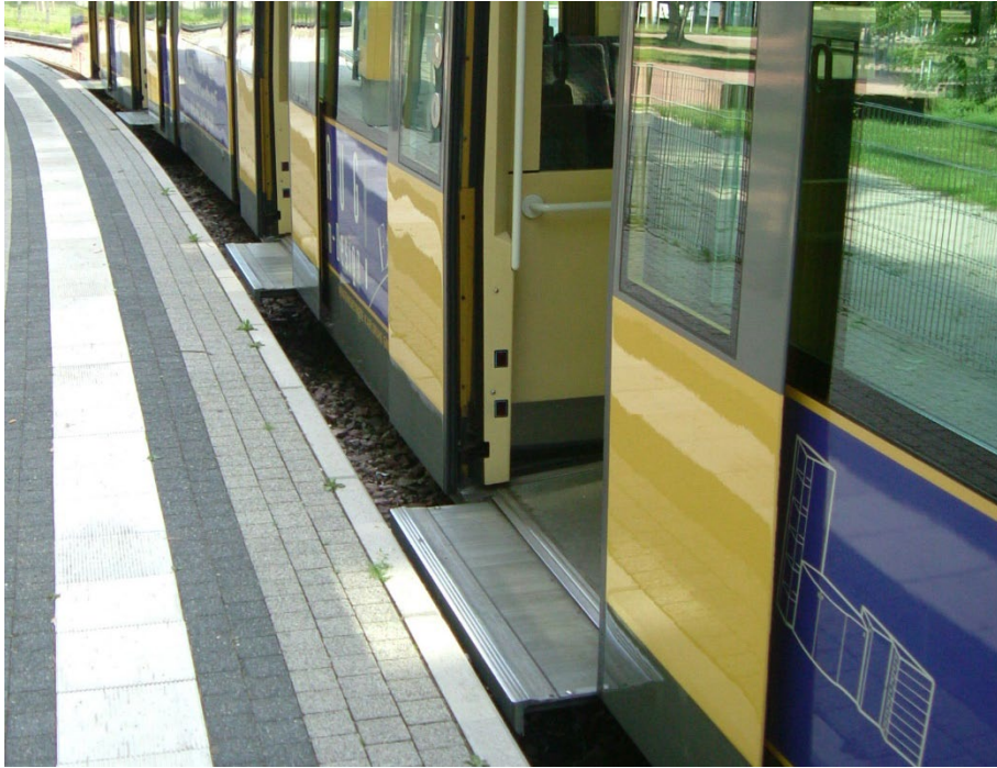
Kuva 10. Duoraitiovaunun kynnyksen ja rautatielaiturin välinen etäisyys täytetään oven kynnyksestä sivuun työntyvällä lipalla. Karlsruhe 30.7.2003 kuva Antero Alku.
