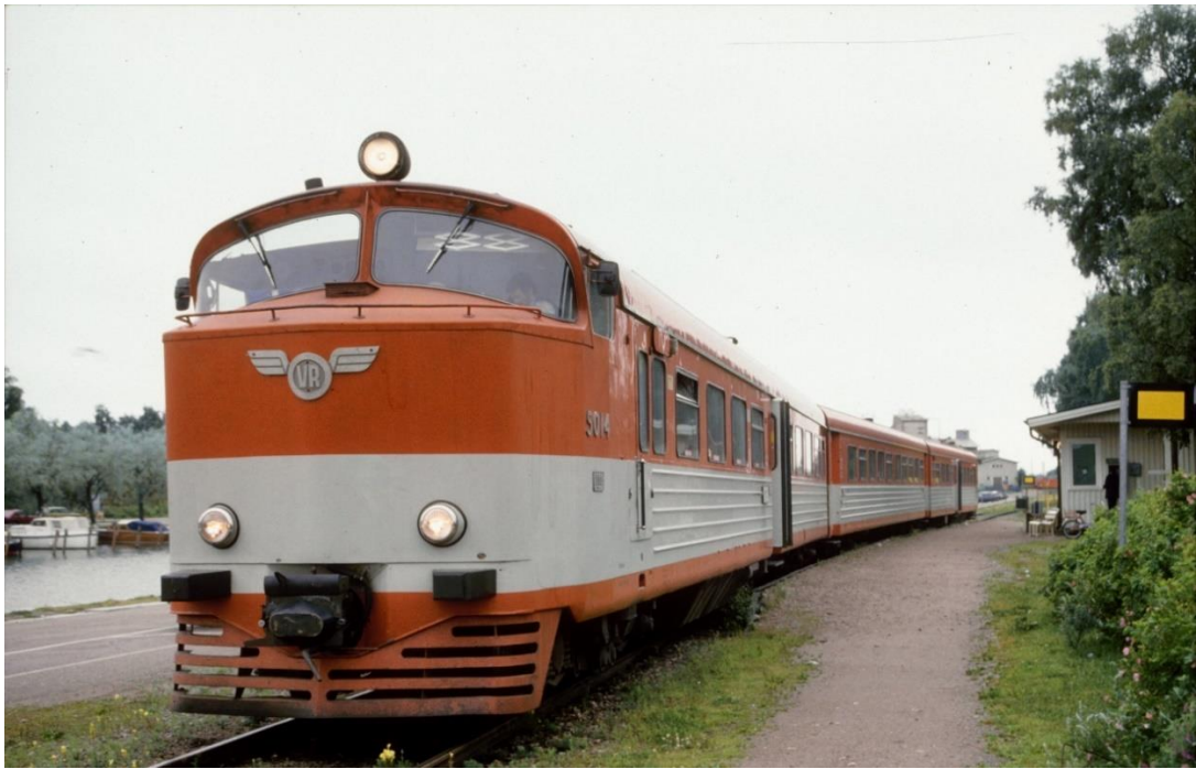
Kuva 1. Kuva n. Dm8-sarjan moottorijuna Uudenkaupungin Kalarannan seisakkeella. Seisakelaituri on noin kahden vaunun mittainen, mutta kolmivaunuisen junan ovisijoittelu mahdollistaa kaikkien ovien pysäyttämisen junaa lyhemmälle laiturille. Kalaranta, 14.7.1984. Kuva: Tapio Keränen.
