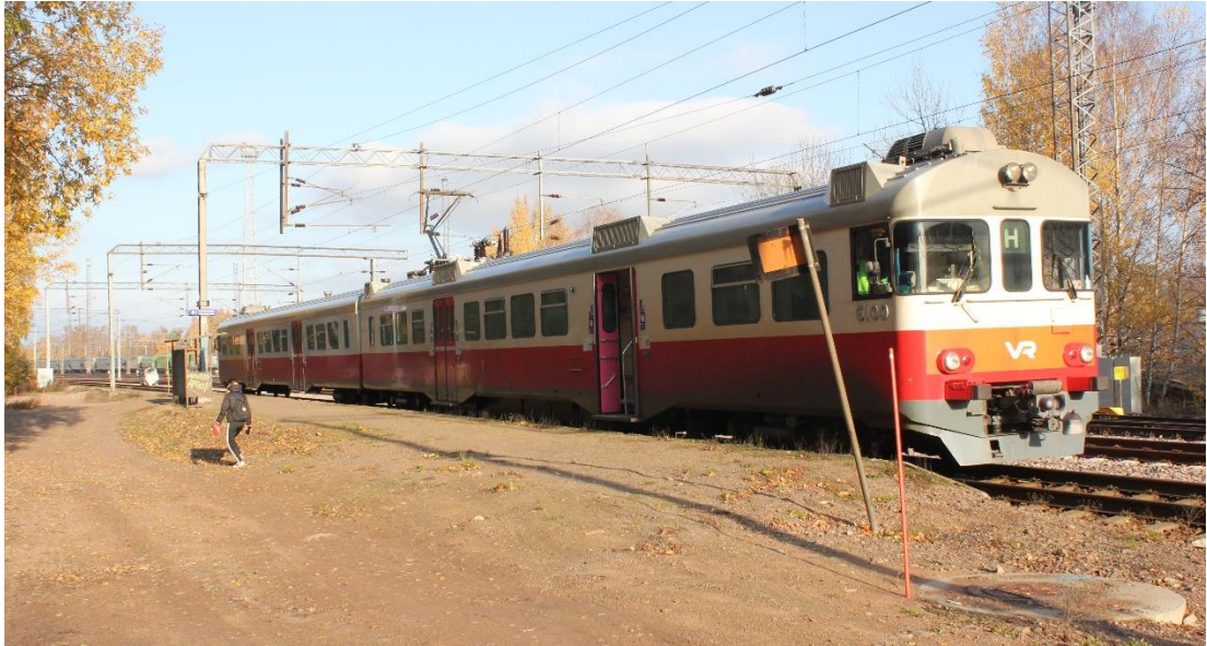
Kuva 8. Paimenportin seisake. Hiekkapintainen ja betonireunainen laiturin on 53 m pituinen, eli yhden Sm2-yksikön mittainen. Seisakkeen varustelu on vaatimaton, pelkkä sadekatos. Ainoa virallinen yhteys seisakkeelle on kapea polku. Paimenportti, 30.10.2020. Kuva: Aarne Alameri.
