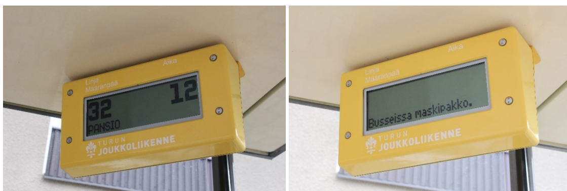
Kuva 7. Bussiliikenteen reaaliaikainen 1-rivinen aikataulunäyttö. Näyttölaitteella on mahdollista esittää myös tiedotteita. Turku, Kerttulinkatu, 30.3.2021. Kuvat: Aarne Alameri.
